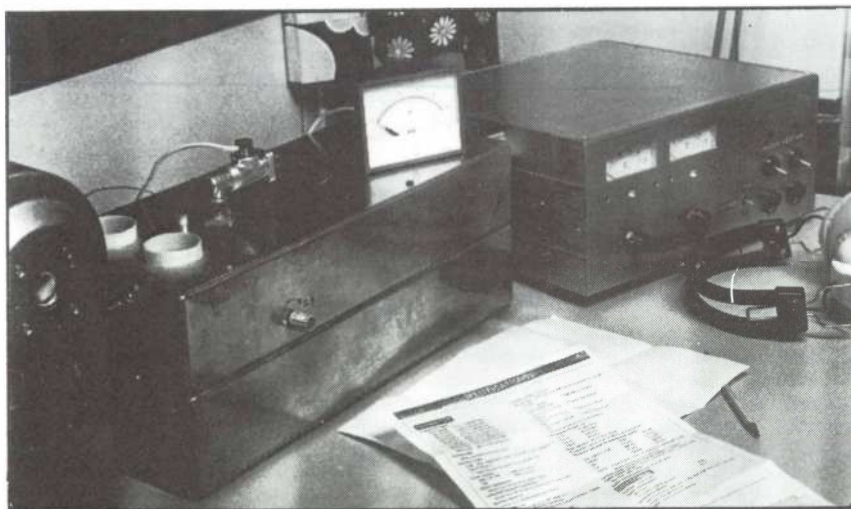
Den linjära 1,2 kW förstärkaren för 144 MHz EME. Tillverkad av AHK-group/Turku.
