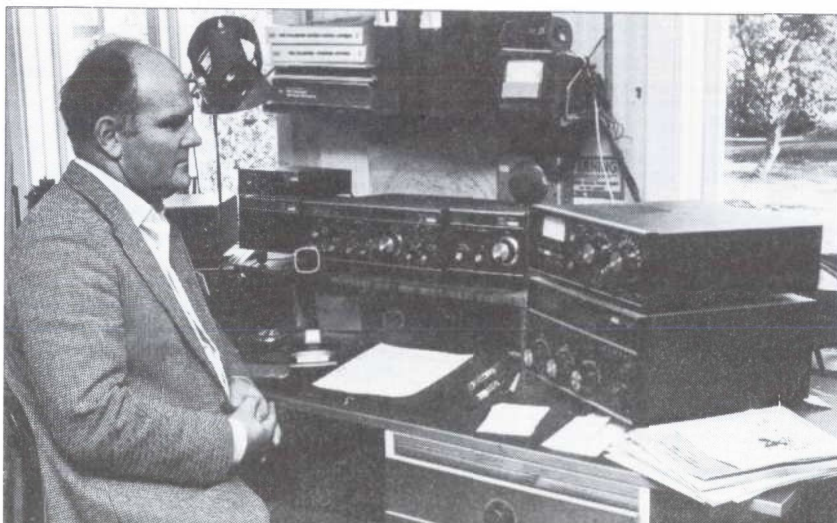
SM5CAK Lars Erik Bohm Motala. Medarbetare i DX-spalten sedan 1973. Rig: Drake TR7/RV75 och L7 slutsteg samt MN2700. Ant.: Hygain TH6DXX + Dipoler, 3 st Sloping dipoles för 7 MHz. Lars fick licens 1958 och har kört 98500 QSO med signalen SM5CAK. Foto: SM7QY.
