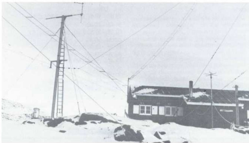
Bilden är ifrån OX3VHF:s QTH. På masten till vänster sitter antennerna för både 50 och 144 MHz fyrarna. Foto via OZ7IS.
