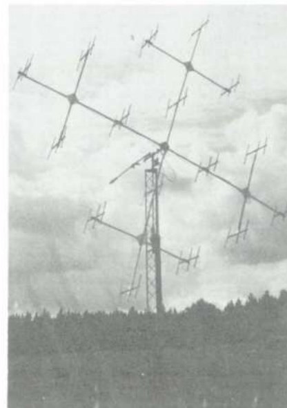
EME antennen hos SK5ID bestående av 16 st 3 el Quad. (Foto: SM5HXQ).
