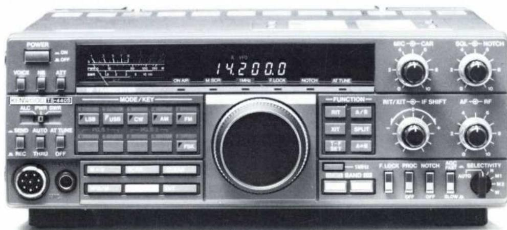
Ny kompakt (270×96×295 mm, 6,5 kg) KV-transceiver med heltäckande mottagare. Dubbla VFO, 100 minnen i 10 banker, USB, LSB, AM, AFSK och FM som standard. Snabb sändning-/mottagningsomkoppling medger full break in (QSK) och klar för AMTOR. Fyra individuella bandbredder 6 kHz och 2,4 kHz standard. 1,8 kHz, 500 Hz eller 270 Hz som tillbehör. Strömförsörjning 13,8 V=, 20 A. Inmatad effekt 200 W pep på alla band och trafiksätt utom AM, 110 W. PS-50 nätaggregat medger kontinuerlig
