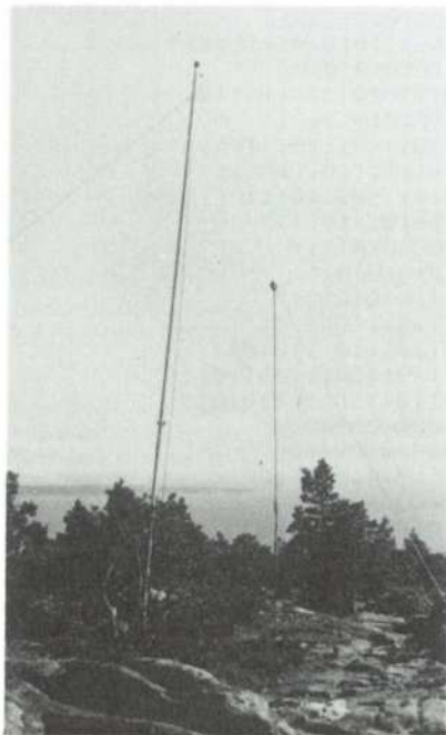
Antenngrejerna utgjordes av två dipoler, slopad resp. inverterad, och fem meter aluminiumrör som mast.
