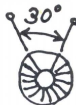
Rätt lindad när lindningen är ut- spridd jämnt och 30°-öppning mellan anslutningstrådarna.
