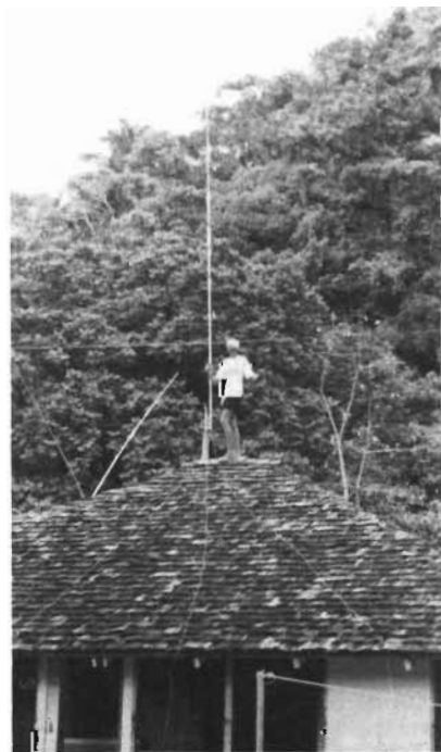
Vertikal c:a 7 M upp med 8 avstämda radialer och 4 st 20 M långa. Tyvärr ett stort berg norrut. Fotot är taget när jag besökte Kiyoko NH6RT/KH8.
