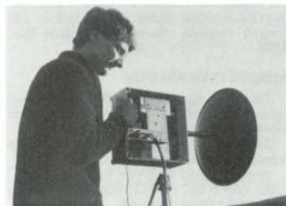
Peder SMØMEM med sin 10 GHz rig 450 \mu W uteffekt riktar sin parabol mot SMØIKR för QSO i microvågstesten.
