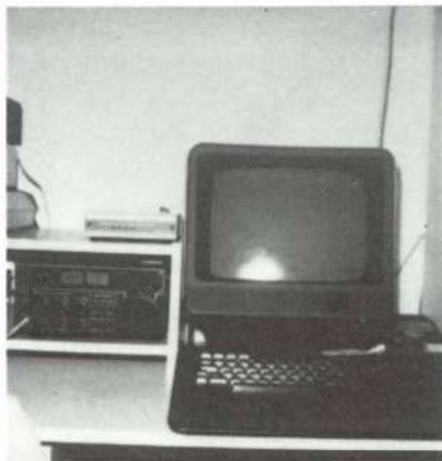
En station för Packet radio: Till vänster rigen med TNC, till höger computern.
