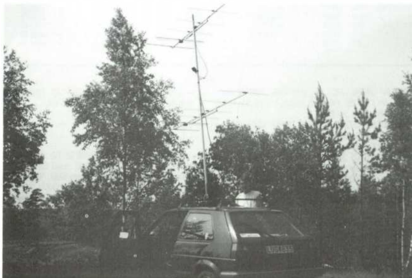
Testkörning! Utr.: FT290R, PA 36 W, 2x6 element + toppen QTH = "toppenroligt" att vara sändaramatör Hi. 73 allihop o på återhörande! -5PZK o -5PRE.
