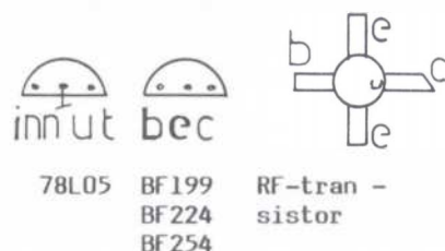
Fig 3. Tilkoplinger for halvledere.
