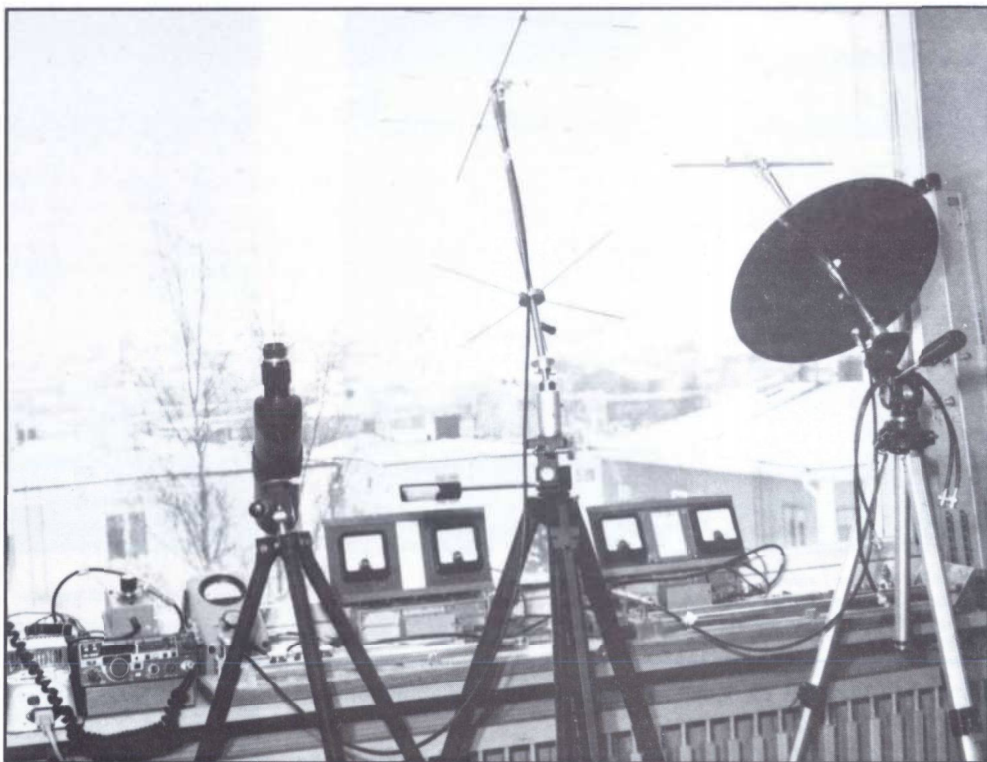
Fig 1 Hela anläggningen i perspektivfönstret. Till vänster sändaren (ICOM 430-440 MHz) kompletterad så att effekten kan regleras från 0,5-10W. En kikare 20 x 60. Bird 43 effekti- och SWR-meter med element för 10, 5 och 2,5 W. Avslutningsmotstånd 5 W. Dämpsatser 1, 2, 3, 6 och 10 dB, 50 ohm.
