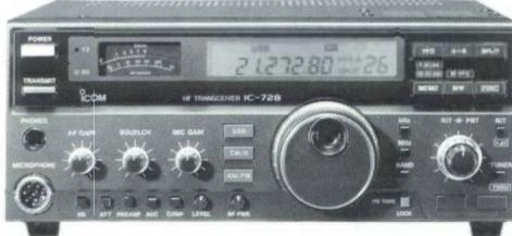
Den perfekta riggen till hyfsat pris och i litet format! 160-10 m. all-mode (AM/FM option). Dubbla VFO. Passband tuning. 26 minnen. AF speech compressor. Dynamikområde 105 dB. Noise blanker. CW semi break-in. Utseende 100 W. Bredd 241, höjd 94, djup 239 mm.
