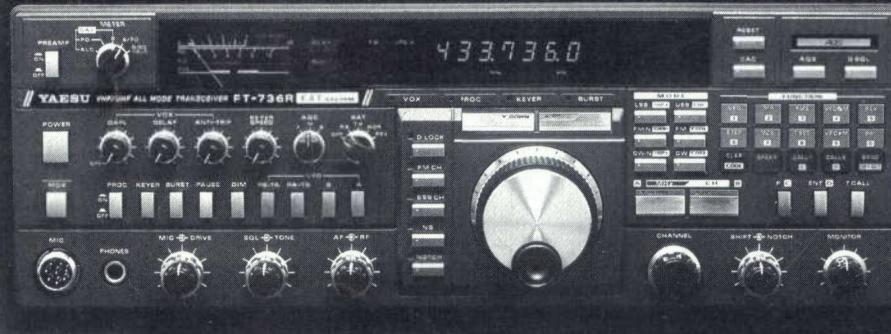
En fulländad transceiver för en fulländad operatör. 25W ut på 2/70. 220VAC/12VDC-drift. Mycket lättskött trots mängder av finesser. Preamp-kontroll och tracking är standard.
