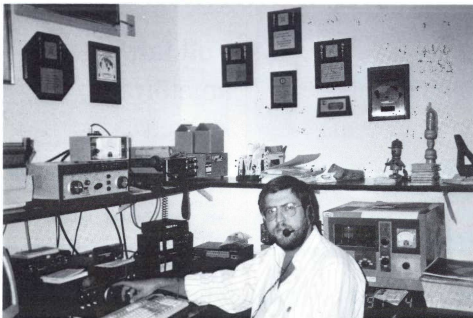
ZP5JCY Luis N Kemper från Asuncion Paraguay har en bra utrustning i shacket: en ICOM 765 med effektsteg TenTec Titan 425, en ICOM 735 med ett hemmagjort 1 kw slutsteg, en ICOM för 6 m och en ICOM 2AT för 2 m. AEA 232 interface för RTTY samt också en PC 386.
