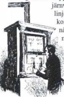
järnvägstelegraf på en kortare linje. Seden de förenklat sin konstruktion till en enkelnålstelegraf med bara en ledning (år 1838 hade tysken Steihel upptäckt att jorden kunde användas som en ledare) slog deras telegrafsystem igenom och kom under lång tid att användas vid järnvägarna.
