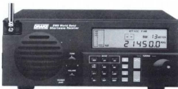
En nykonstruerad kommunikationsmottagare från välkända Drake. Helt portabel, men med finesser som endast återfinns i större stationära mottagare. Frekvensområde 500 kHz till 30 MHz, 87 - 108 samt 118 - 137 MHz. Trafiksätt SSB, AM/FM. Tre inbyggda bandbredder ( 6.0, 4.0, 2.3 kHz)
