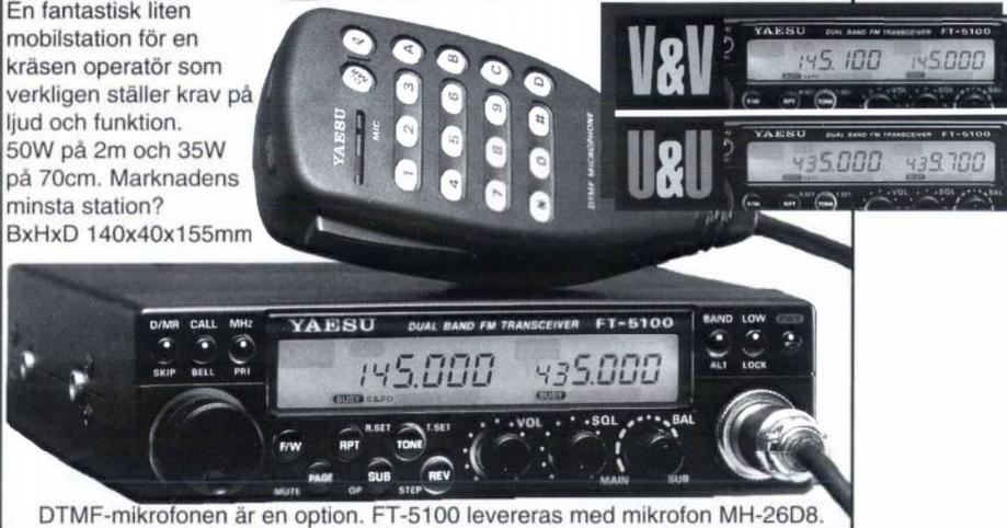
DTMF-mikrofonen är en option. FT-5100 levereras med mikrofon MH-26D8.
