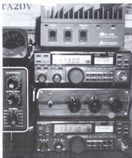
Satellitstation å la SM0SFG/Stig. TR-851E all-mode transceiver för 70 cm (nederst), hembyggd 137 MHz mottagare för vädersatelliter, TR-751E allmode 2-metersrig och överst ett 100W slutsteg för 70 cm, RFC 4-110.
