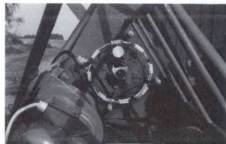
Här syns indikeringen med sina åtta lägesgivare. Framtill till vänster på bilden skymtar drivmotor och växelåda.
