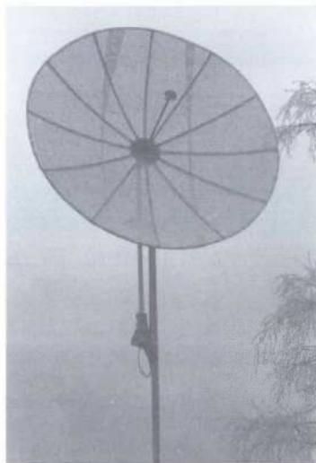
2,5 meters nätparabol placerad 12 meter ovan marknivå. Parabolen är konstruerad av SM4DHN
