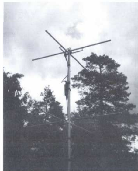
Enkel antenn byggd av två 2m-dipoler kompletterat med två reflektorspröt. Foto: SM7RIN
