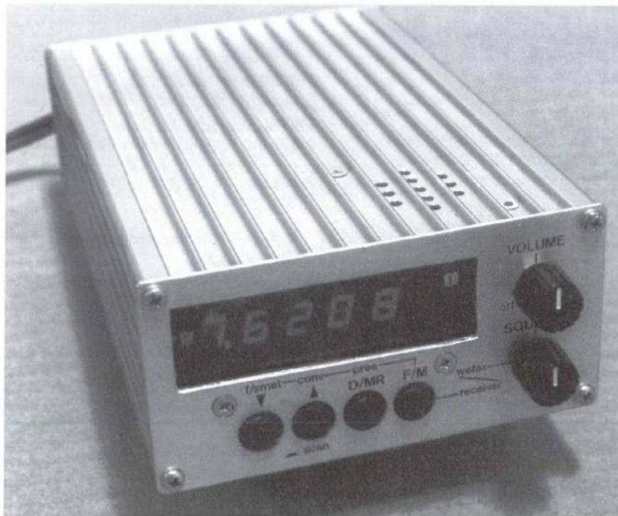
Den färdigbyggda vädersatellitmottagaren. Foto: SM7NDX
