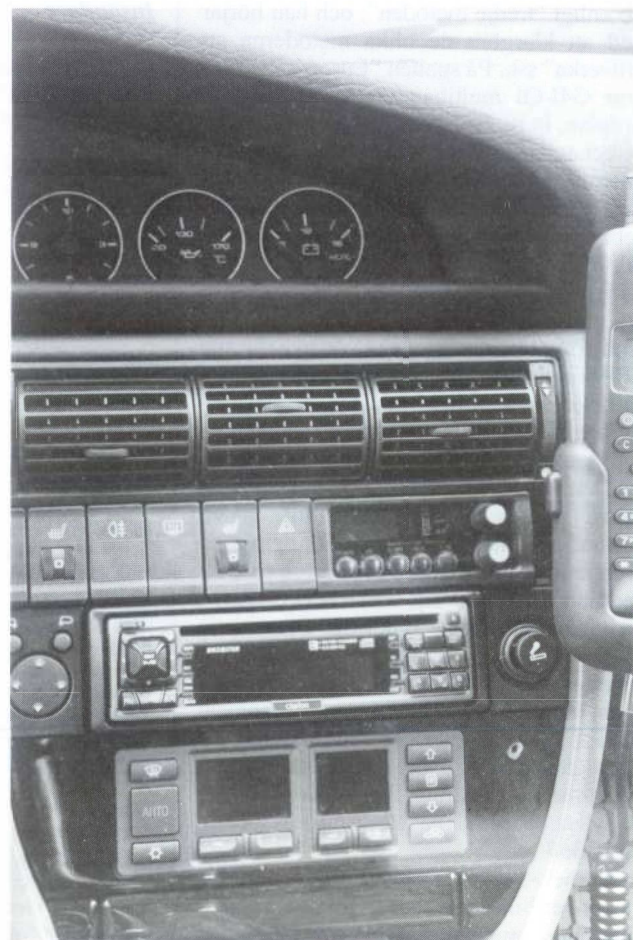
Med lite fantasi kan radion smälta väl in i bilens interiör, här i förf. Audi A6. Endast den bakgrundsbelysta panelen är synlig, själva radio (duobanderversion) ligger under baksätet. Foto SM7NDX/Jan.
