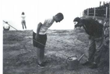
En fylld vattenkanna fungerar fint som "beam-stopper", när man inte har någon rotor.
