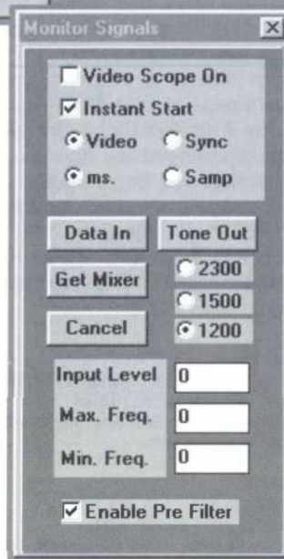
Bild 2a. Meny för att ställa in signalnivå. Genom att klicka på den blå ikonen med ett öra i ett nyckelhål så kommer gardinen Monitor Signals upp på skärmen. Klicka bort Video Scope On om den är till och klicka på Data In. Om du har en SSTV-signal under mottagning syns aktivitet i fälten för Input Level, Max. Freq. och Min. Freq. Om du har Windows 95, dubbelklicka då på den lilla högtalarikonen längst till höger i skrivbordets aktivitetsfält.
