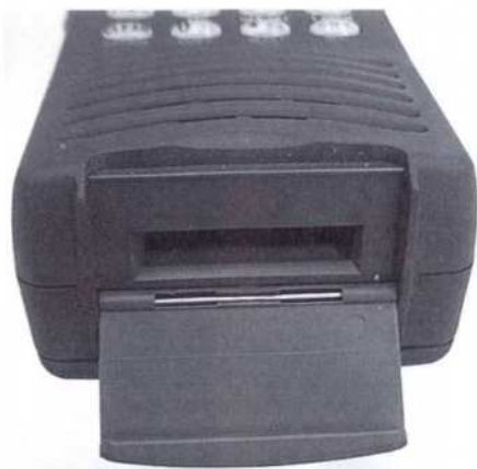
Då MW-antennen ej används skyddas uttaget av en skjutlucka.
