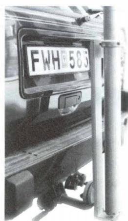
*Mastfoten monterad på fordonskulpan, en standardkonstruktion som tagits fram av Signalmekano. Den klarar vikter upp till 6 kg och 4,5 meters höjd.*
