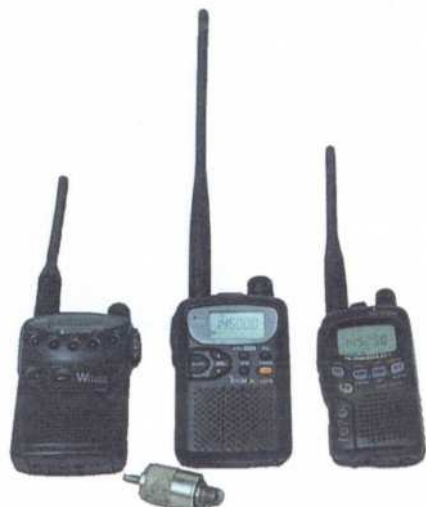
Liten, aningen större och minst. Tre duobandare i ministorlek, Standard C508, Icom Q7E och Yaesu VX-1. Jämför storleken mot PL 259-kontakten!
