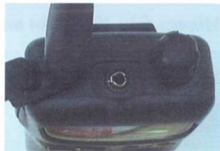
För att ansluta yttre hörlur och/eller mikrofon på Q7E krävs en speciell 4-polig 3,5 mm plugg som måste köpas extra.
