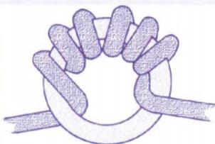
Att linda upp en kabel på en ferritstav eller en toroid är en vanlig standardlösning för att stoppa HF, men det gäller att välja rätt utförande (material och antal varv) och att placera den på rätt ställe.
