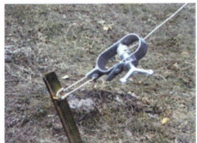
Linsträckaren med anslutning till förankringspinnen. Vredet är försett med ett fjäderbelastat lås som gör
