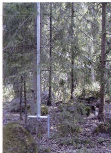
Den nedre delen av antennen, med bottenfästet och den grova delen av röret som går upp längs trädstammen.
