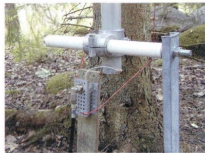
Antennens isolerade bottenfäste och den hemmagjorda anslutningen för koax och de upphöjda radialerna.
