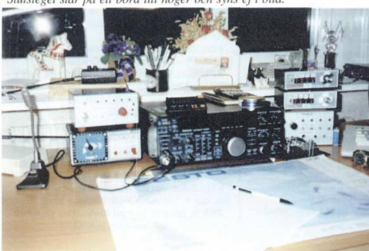
Kenwood TS-850. Till vänster syns rotorstyrning samt antennomkopplare för beverageantennen.
