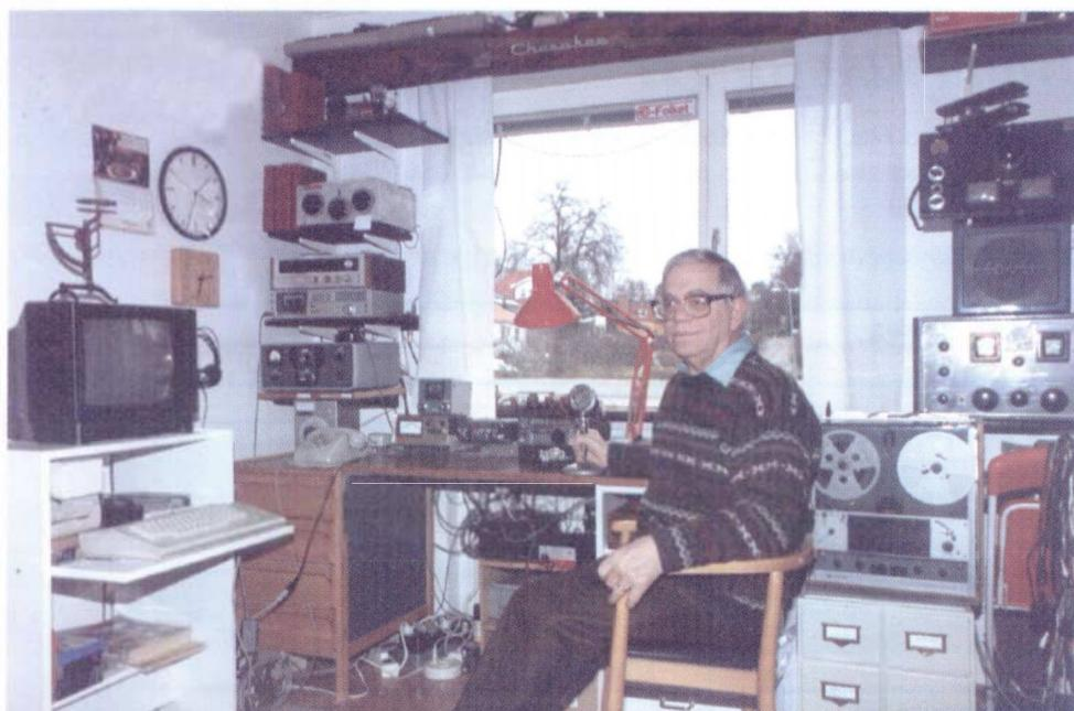
Nuvarande station hemma är IC 756, Collins slutsteg, hembyggd avstämningssenhet, Mosley 4-elements beam för 10, 12, 15, 17 och 20 meter. Vidare ett Versatower och en dipol för "the low band"s. För information utifrån har jag en dator och ett modem för clustret. Slutligen har Internet kommit in i shacket. I reserv finns en Cushcraft trebandsbeam och en Icom IC 735.
