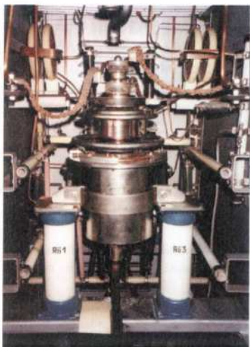
Också imponerande - rör i slutsteget (Sändare nr 23).
