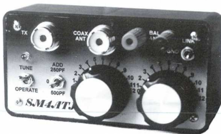
ZM2, en liten, mycket duktig, antenntuner i byggsats.
