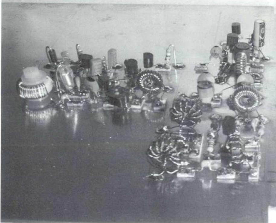
Ingångssteg med DBM och tillhörande trifilärlindade transformatorer i förgrunden.
