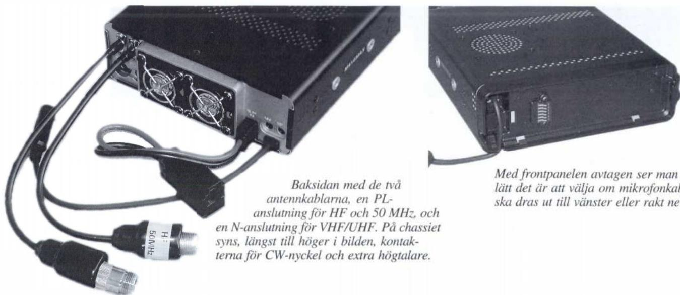
Baksidan med de två antennkablarna, en PL-anslutning för HF och 50 MHz, och en N-anslutning för VHF/UHF. På chassiet syns, längst till höger i bilden, kontakten för CW-nyckel och extra högtalare.
