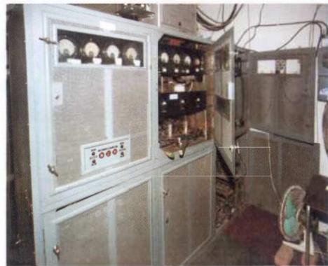
Den 2.5 kW hembyggda sändaren är i behov av en genomgång.
