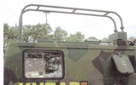
Halvloop för kortvåg monterad på terrängbil
