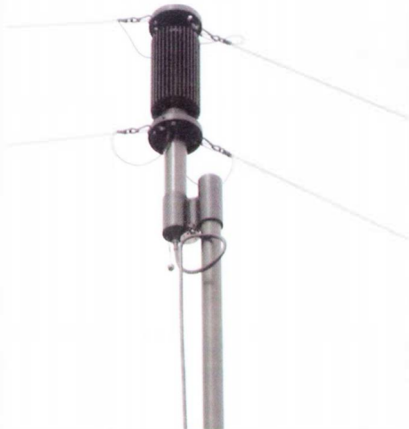
... ytterligare en TFD-antenn, med motståndet monterat vertikalt tillsammans med balunen.
