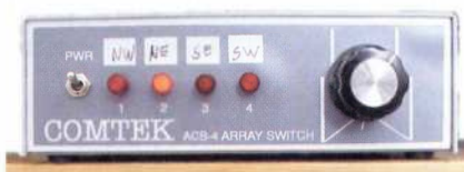
Manöverbox Comtek ACB-4 för 80 meters vertikaler. Fyra antenneriktningar kan väljas.
