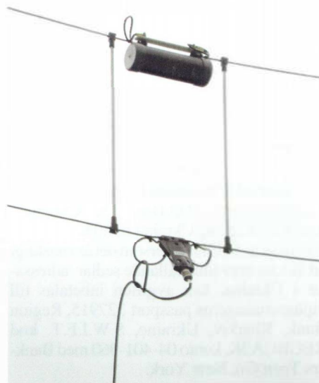
Mittendelen på en antenn av typ TFD, med spridare och avslutningsmotstånd
