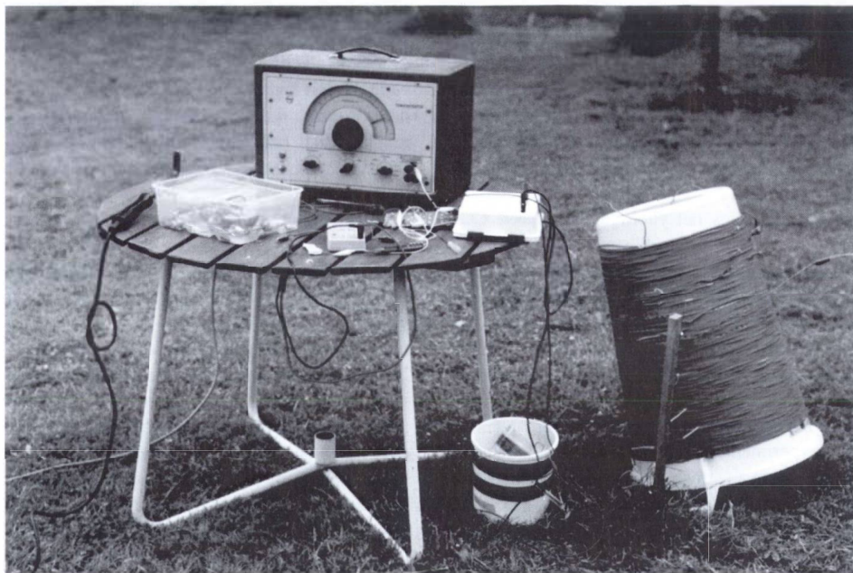
Spolen samt variometern på marken, min gamla Philips tongenerator och en vit plastlåda innehållande en anpassningstrafo.
