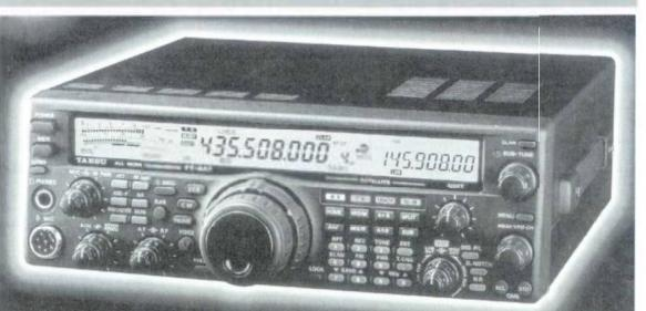
Allmode KV,50,144,432 100W (50W 2/70). Satellit-duplex gör den här stationen fulländad som allround rig. Drivs enbart på 12VDC.
