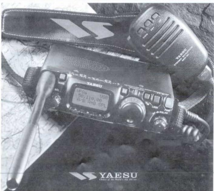
En unik konstruktion utan motstycke. Kan förses med batterier antingen torrceller eller laddbart NiCd-pack (tillbehör). Inbyggd elbugg och VOX. Två antennuttag.
