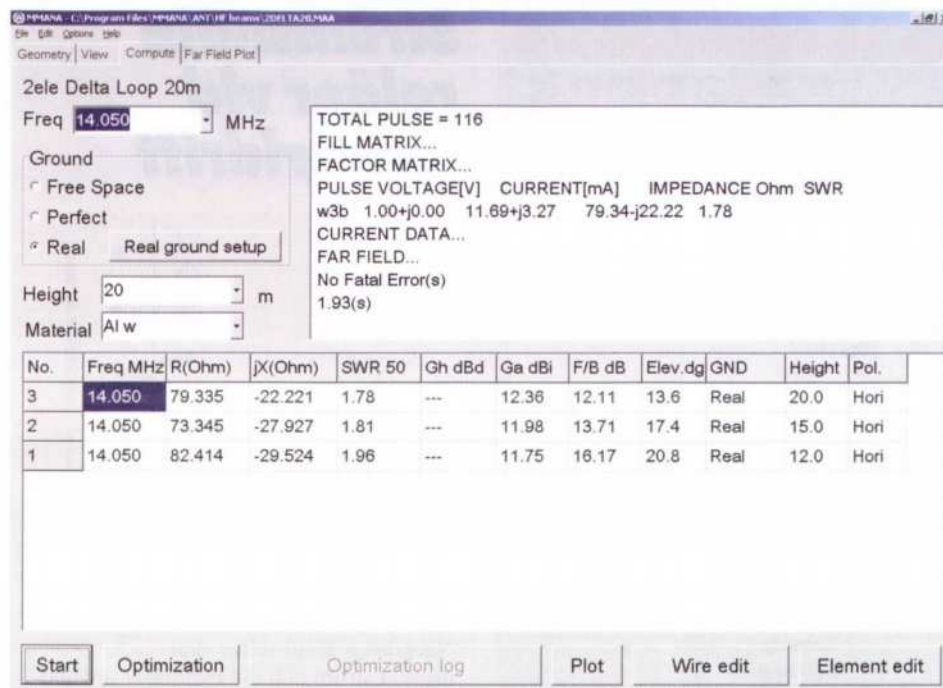
Figur 2: Resultatfönster. Visar där data från tre successiva simuleringar. Fönstret visar bl a värden för impedanser, SVF, förstärkning, F/B och lobvinkel vid tre successiva körningar med värdena 12, 15 och 20 på anten nhöjden. Varje simulering har tagit ca 2 s (på en Pentium II, 450 MHz).
