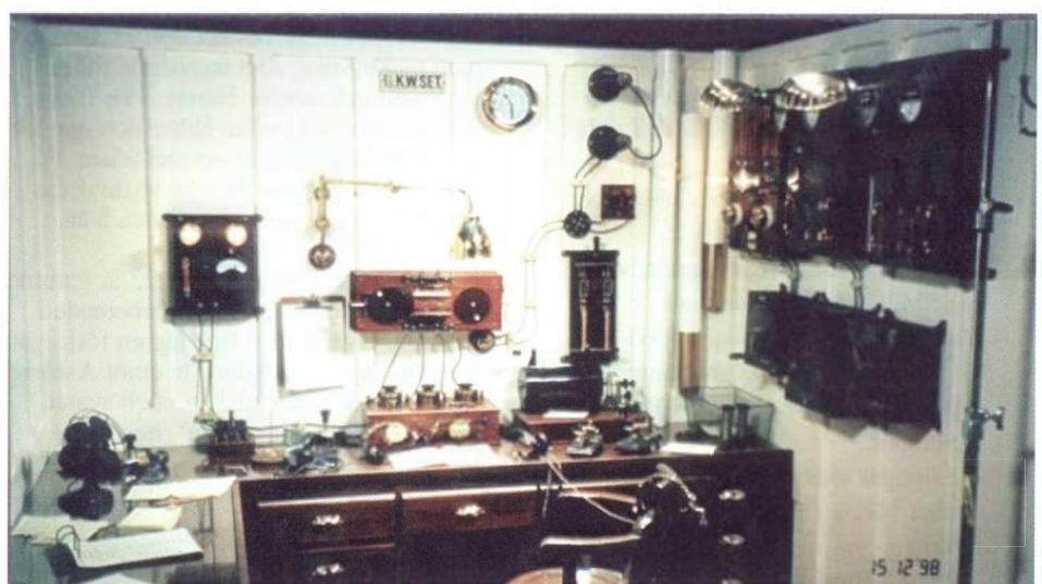
På denna bild så ser man bättre hur detektorn och tunern ser ut. Reservsändaren med sina små gnistgap bakom nycklarna. Denna bild är också från filminspelningen.
