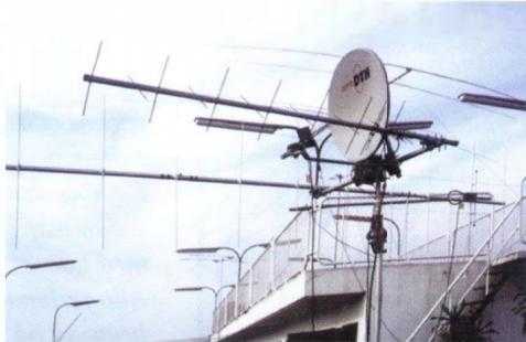
Här syns AO-40 antennerna i förgrunden. Vi hade en kryss-yagi för 70 cm och en Ku-bands disk med en helix matning för 2.4 Ghz. Dessutom en 13 el 2 meters beam på samma stativ. Den användes för kommunikation med HS-land som ju var på andra sidan av floden. Bakom disken skyntar en C3 och längre bort en HB9CV. Dessutom hade vi en dipole med öppen steg matning som gick väldigt fint på alla band.
