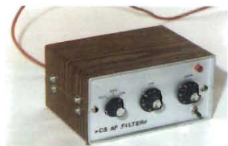
Figur 7. CW-SSB filtret inbyggt i en låda.
