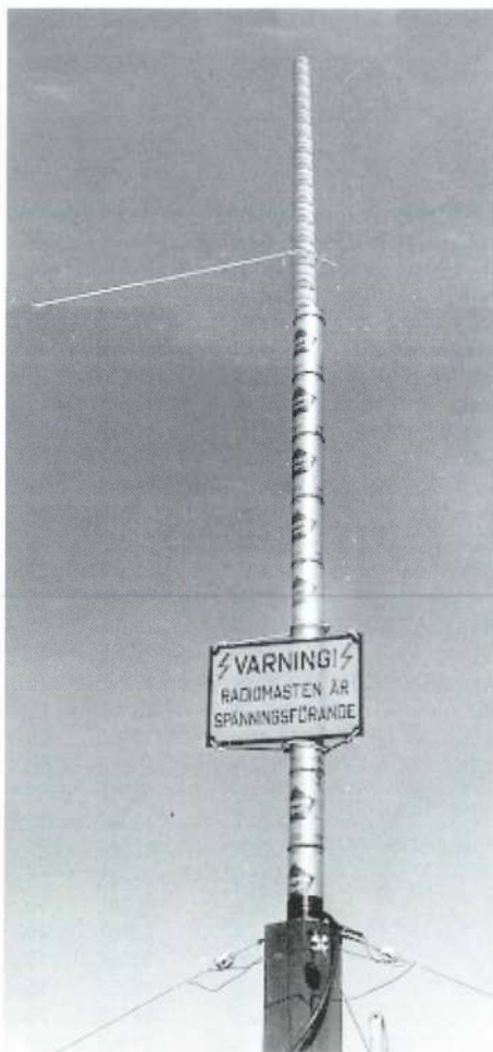
GP-antenn för 20m bestående av 33 st Pripps Special ölburkar. Foto tillställd QTC av SM6BLT Bengt Lindberg
