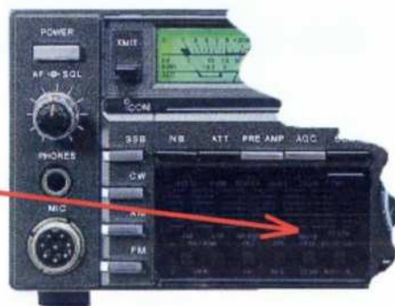
På ICOM IC-735 är VOX-funktionen med dess reglage placerade under en nerfällbar skyddslucka.
