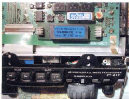
YF-122C/XF-115C (svart låda med blå etikett) monterad i FT-817
