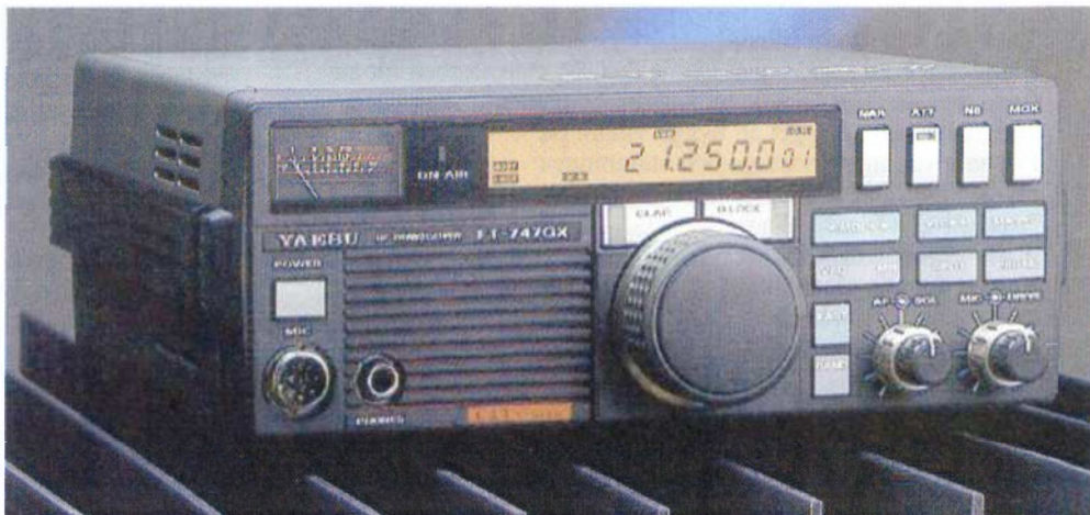
YAESU FT-747GX. BxHxD (cm) 238x94x275. Representerar en "no frills" rigg som har precis det du kan behöva och kanske lite till för en vettig slant. Mottagaren är heltäckande så att man kan även använda den för att lyssna på rundradio på kortvåg.
