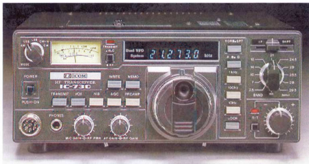
ICOM IC-730. BxHxD (cm) 241 x 94 x 275. Riggen är liten och nätt till formatet men har fortfarande lagom stora knappar för enkelt handhavande. En IC-730 borde hamna i pris på runt 2500 – 3000.-.
