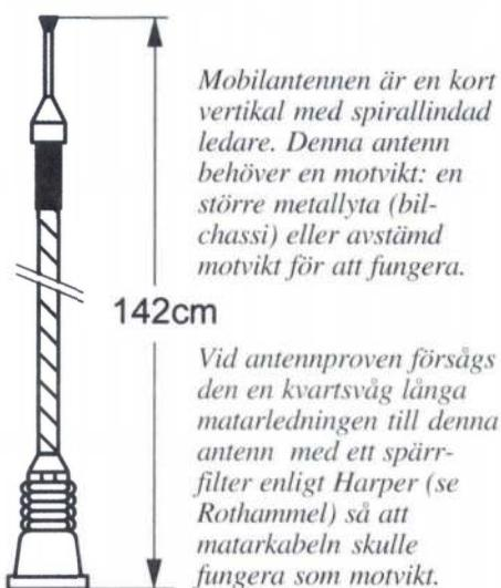
Figur 6 MicroDip - "första generationen"
