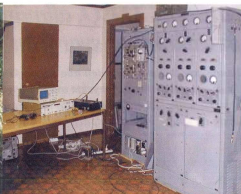
SL3ZV, op SM3UKE. Heavy duty! TX: Standard Radio CT450, RX: Standard Radio CR304A. Antenn: Dipol. Dessutom ett gammalt HP-oscilloskop för modulationskontroll och ett Tandberg kassettdäck som fick agera mik-förstärkare.
