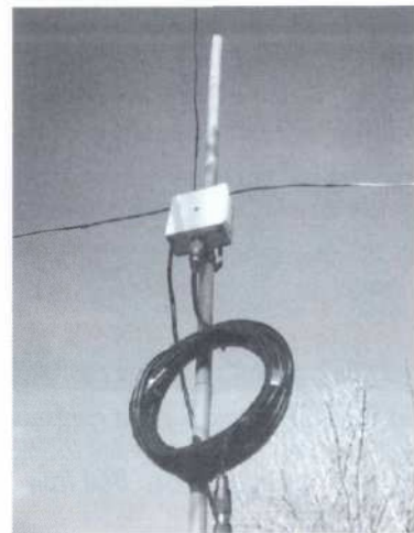
Fig. 4 visar hur antennen utförts mekaniskt vid matningsanslutningen. Matningen (koaxkontakt) sitter i mitten på lådans (el-dosa IP-54) underkant med RG-58-stumparna (kondensatorerna C1 och C2) på vardera sidan om matningen.
