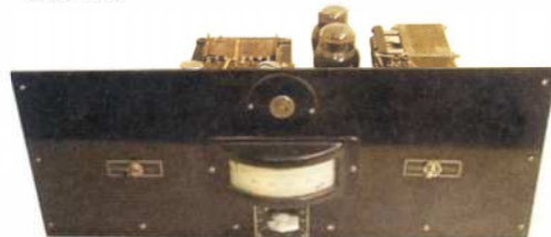
Modulatorns panel med det stora anodströmsinstrumentet
