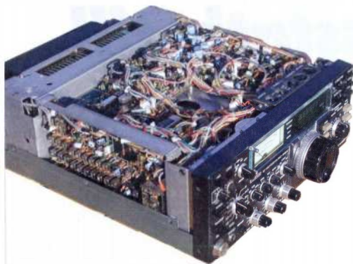
Mycket mekanik, kretskort och kablage = dyr tillverkning. IC-740 med locket av.
