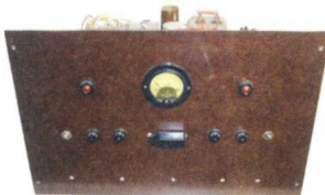
Kraftenhetens framsida med huvudströmbrytaren och voltmeter i mitten
