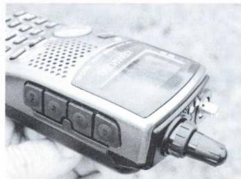
På riggens högersida återfinns inkopplingsmöjligheter av GPS, PC, mikrofon och högtalare/lur. Antennkontakten är av typen SMA
