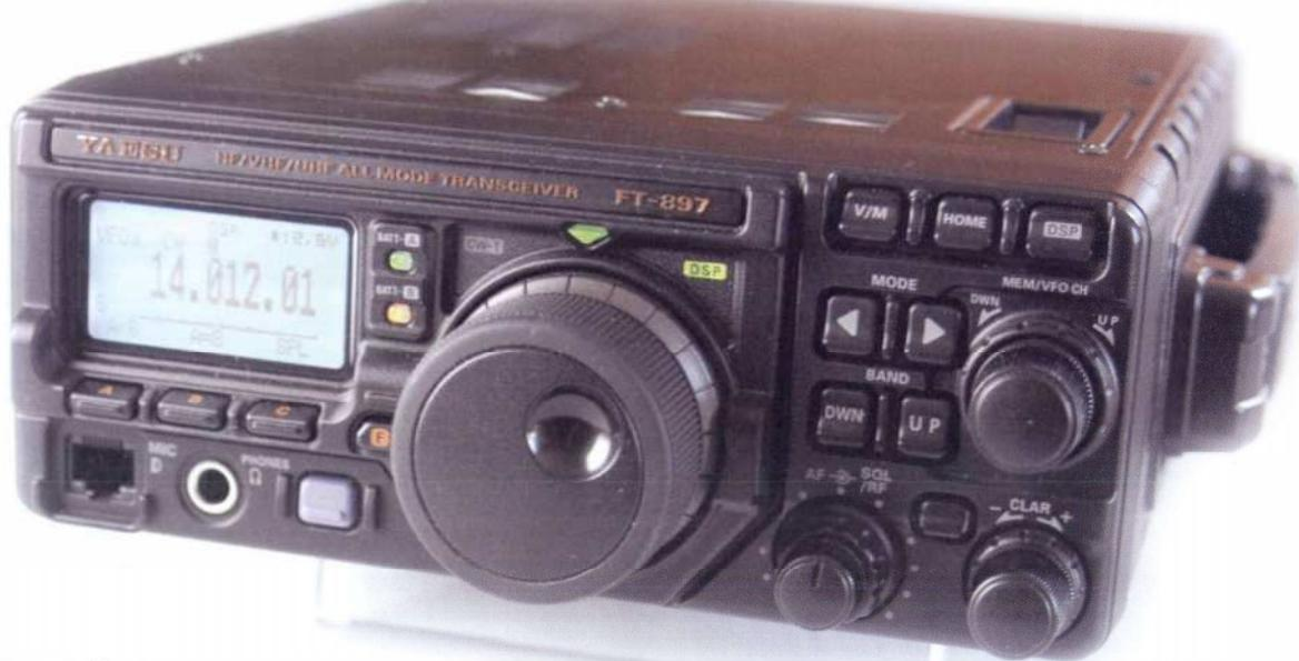
mycket snygg. Både utanpå och inuti. Yaesu kan det där med design. Och rejäl, ett gjutet aluminiumchassi bådar gott för stabilitet. Man har också lyckats med kylningen och tillhörande fläktljud. Andra mindre riggar blir ofta ganska eller i vissa fall mycket varma och samtidigt högljudda. Men Yaesu har klarat att hålla temperaturen nere och samtidigt fläktljudet till en vettig nivå.
