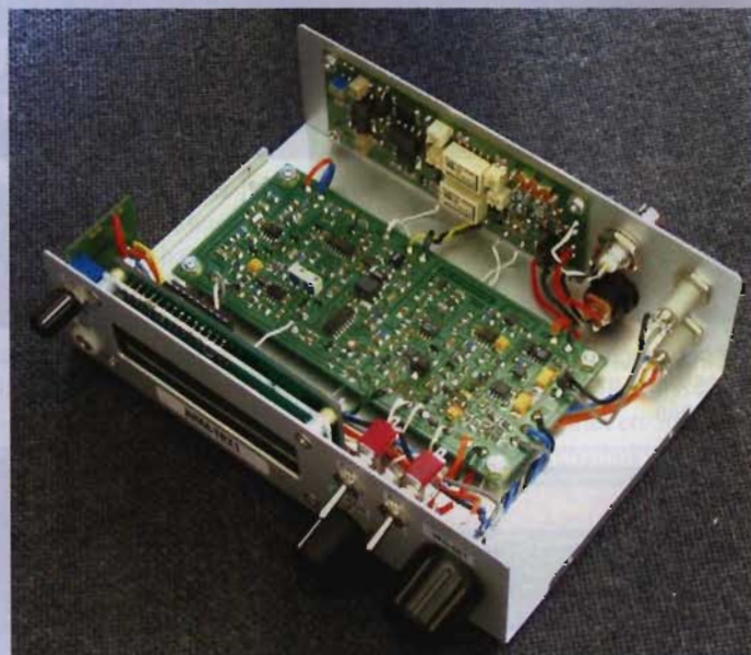
Läcker så att det förslår. Här JUMA-TRX uppbyggd av 3 kretskort och ytmonterade komponenter. Tekniken bygger på det klassiska konceptet "direktblandning". På baksidan kan man se PA-kortet som ger hela 5 watt uteffekt.
