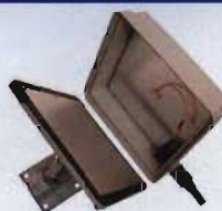
Wlan antenn PRG-2400 Accesspunkten monteras innuti antennen vilket elimineras behovet av dyr och förlustbringande coax. Gain 18 dBi.
