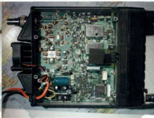
DR620E är lika välbehård med ytmonterade som "lillebror". Fläkten i aktarna ser till att värmeavledningen påskyndas. Notera att undertecknad kurerar färgiga PL-kontakter till BNC medels adapter.
