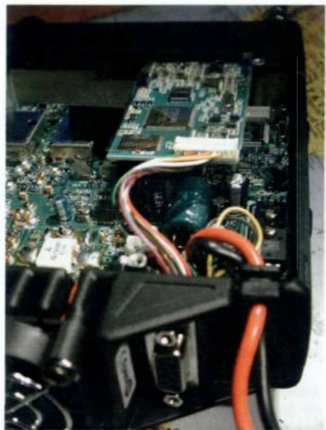
Här har DR-620E utrustats med en TNC och en kontakt på riggens baksida. En "operation" som är över på 5 minuter och ger mycket funktion.
