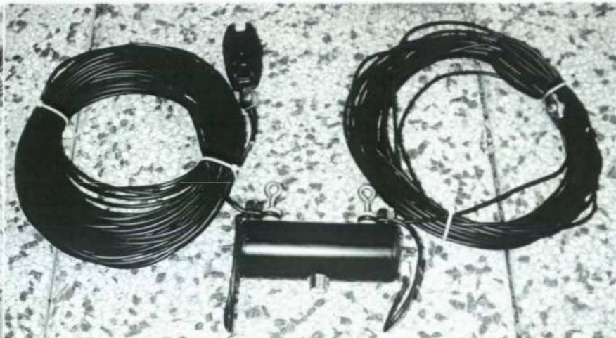
Windomantennen (FD-4) från DXSR levereras med en till synes mycket välbyggd 1:6 balun.
