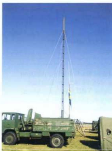
Dipolantennen monterades i F17:s portabla 30 m höga mast.
