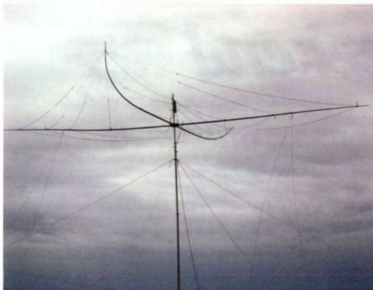
Portabel lättviktsbeam á la Spider; byggmästare är SMÖGNS Peder.
