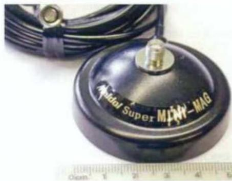
Flytta ut handapparatsens antennen till utsidan på en magnetfot. Finns med både för riggar med BNC eller SMA-kontakt
