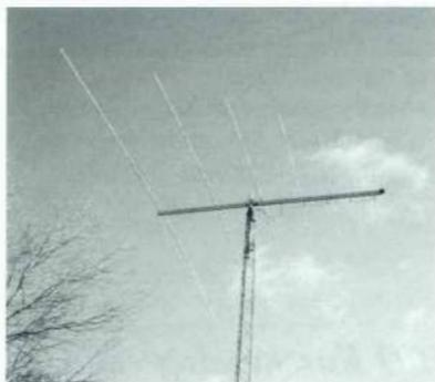
Borgeson Logperiodic 20-10 täcker alla fem amatörradiobanden mellan tio och 20 meter. Och den är både kompakt och diskret, bomlängd endast 5 meter.
